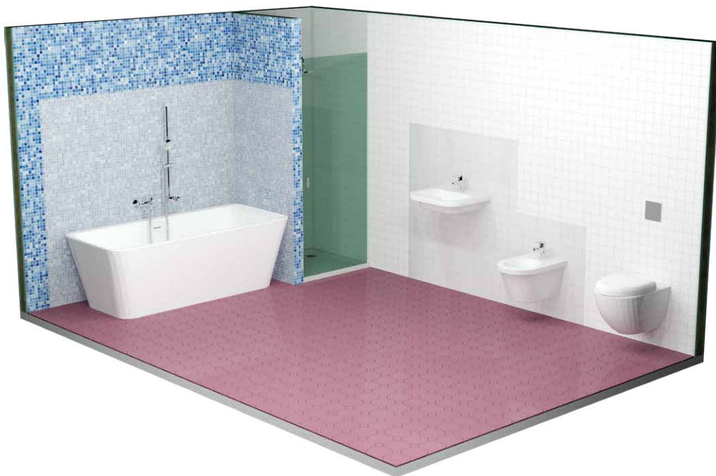
Фиг. 37. Участъци от стените на банята, които са особено изложени на въздействието на вода (обозначени в сиво)
