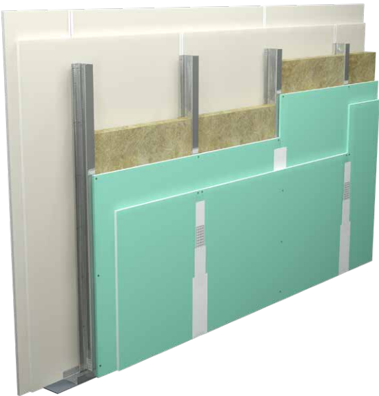
Изглед на стената от страната на помещението с повишено ниво на влажност (напр. баня, кухня)
